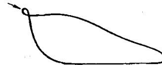
Bild 15. Zu hohe Verdichtung, Einströmung und Ausströmung zu spät
